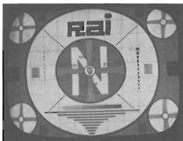
Fig. 4.180. - Immagine di dimensioni ridotte per la tensione di rete di valore basso o per regolazione errata della larghezza e dell'altezza.
