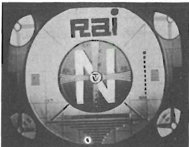
Fig. 4.181. - Immagine prodotta dal ronzio sul video: perdite nell'isolamento fra filamento e catodo dell'amplificatore a VF o di un amplificatore RF e FIV (ronzio a 50 Hz).
