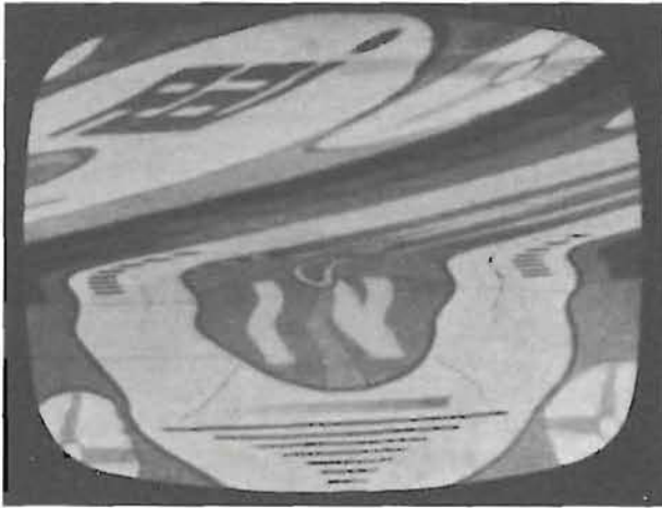
Fig. 4.122. - Immagine contorta per ronzio a frequenza di rete sull'oscillatore di riga.
