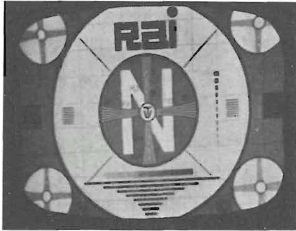
Fig. 4.200. - Immagine stretta ottenuta per il cortocircuito fra alcune spire di una delle bobine di deviazione orizzontale collegate in serie.
