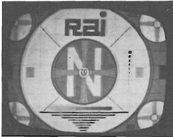
Fig. 4.206. - Immagine ottenuta per riflessione del segnale sull'antenna.
